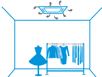
Distribuzione dell'aria con filtro sporco
